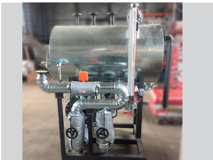
Московская область Изготовление и поставка блочного теплового пункта и конденсатной станции для пищевого предприятия
